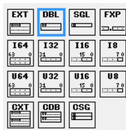
Obrázek 1 - Menu representation s možnými datovými typy pro operátory.
