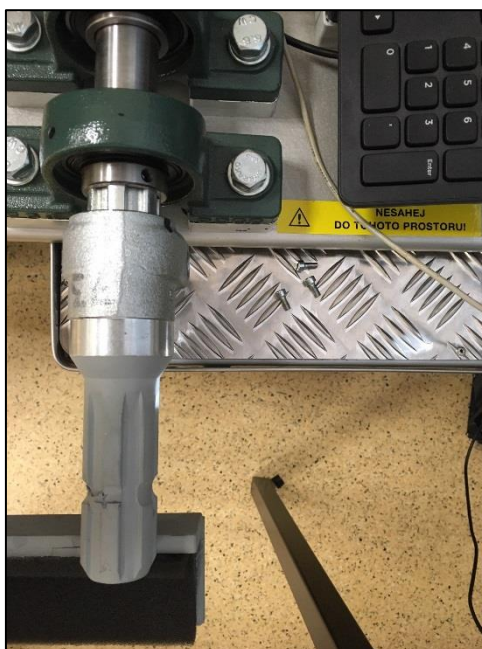
Obr. 5: Zapojení hlavice torzní páky do NCTT-500
