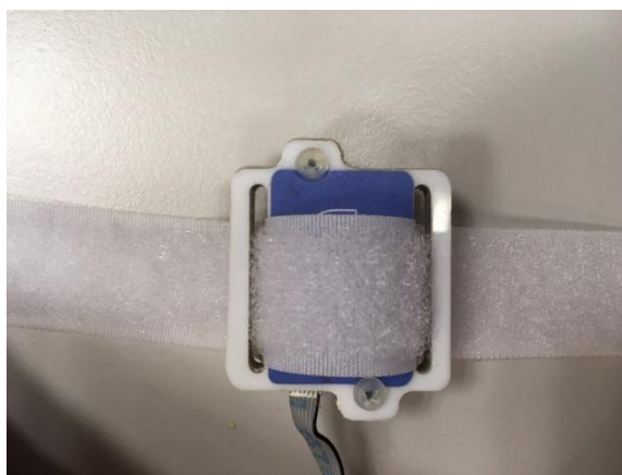
Obr. 2: Body Microelectromechanical System – 6 s upevňovací páskou
