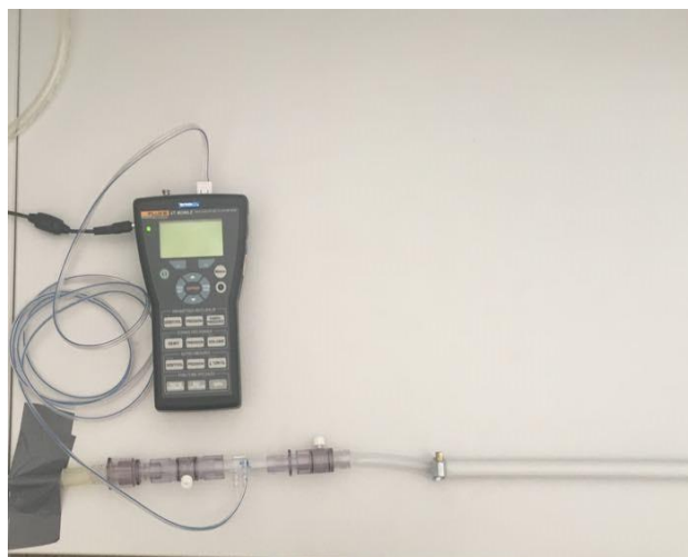
Obrázek 9: Analyzátor průtoku plynu zapojený v měřicí trati
