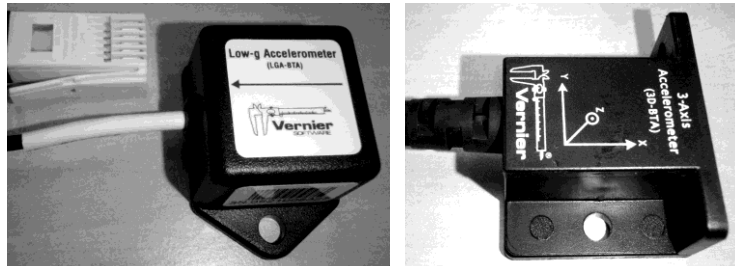
Obr.1: Jednoduchý jednoosý a tříosý akcelerometr firmy Vernier, (převzato z návodu k přístrojům Vernier).
