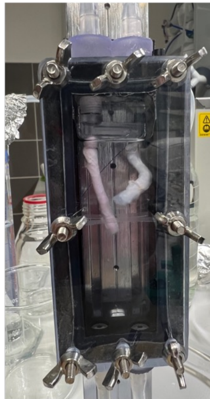
Komora s průtočnými trny pro cévy
