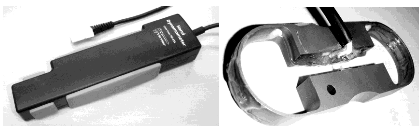
Obr.2: Využití tenzometrického snímače v dynamometru pro měření síly stisku ruky.
