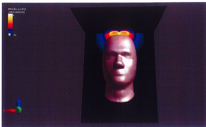
Obrázek č. 3: Rozložení magnetické indukce v rovinách XY a ZX
