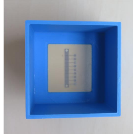
Senzor v nádobce pro pilotní experimenty s fantomem „prasečí krev + glukóza“
