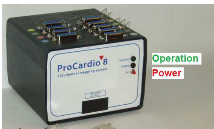
Obr. 9: Označení indikačních LED na čelním panelu ProCardio8.
