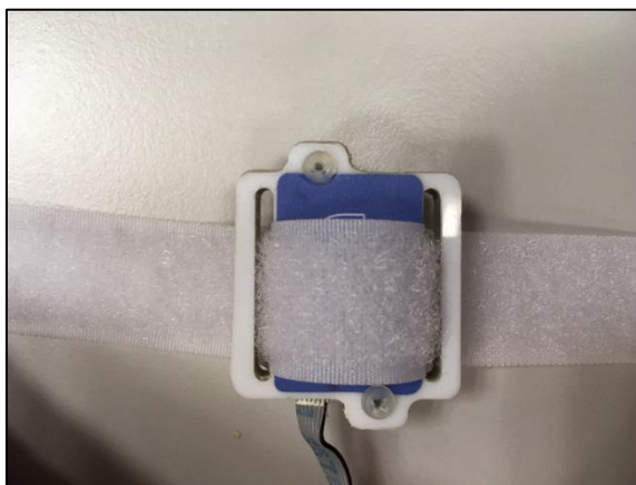
Obr. 1: Body Microelectromechanical System – 6 s upevňovací páskou
