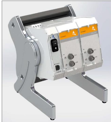
Obr. 3.4. Vyhodnocovací jednotka umožňující připojit buď čtyři optické vlákna s jedním senzorem anebo jedno optické vlákno se čtyřmi senzory (FISO Technologies Inc. Datasheet Temperature Sensor Medical — MC-00234).
