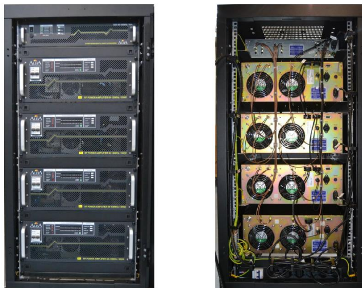
Obr. 3.1. Přední a zadní strana systému zkládající ho se ze čtyřkanalového generátoru (DDS) a vektor voltmetru, který napájí čtyři zesilovače.
