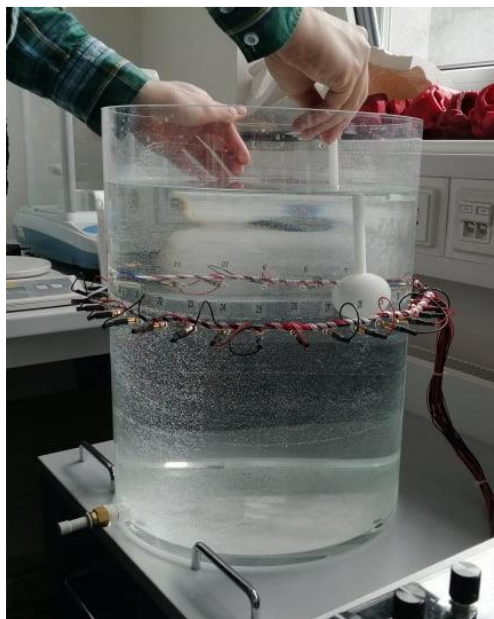
Kruhový vodní fantom s integrovanými elektrodami a vloženou nehomogenitou
