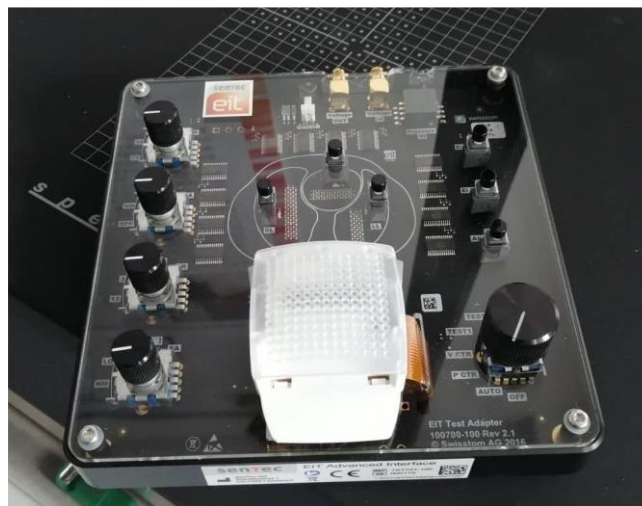
Elektronický simulátor impedance při dechové a srdeční aktivitě (EIT Advanced Interface)
