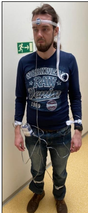
Obr. 3: Umístění měřících jednotek BMEMS-6-V1
