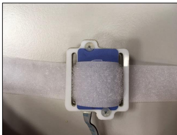
Obr. 2: Body Microelectromechanical System – 6 s upevňovací páskou
